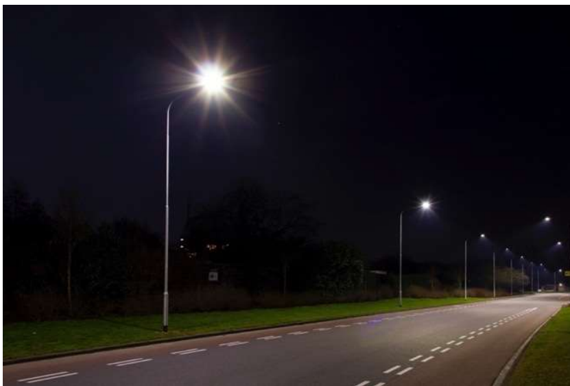
Foto: Brinkenweg in Emmen met een gelijkmatige lichtverdeling zodat er geen zwarte vlekken zijn.
